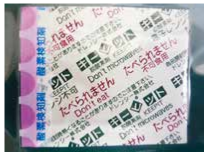
新開発した幅5mmの酸素検知剤(左端ピンク色のテープ部分)
