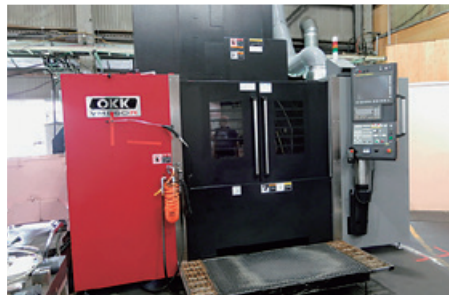
高精度な5軸マシニングセンターを導入
