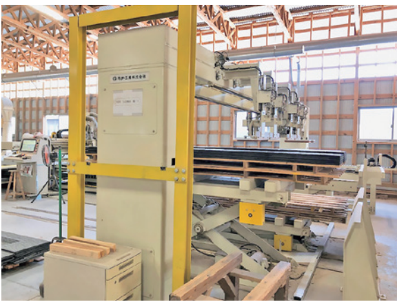
専用加工機による外壁材のプレカット風景
