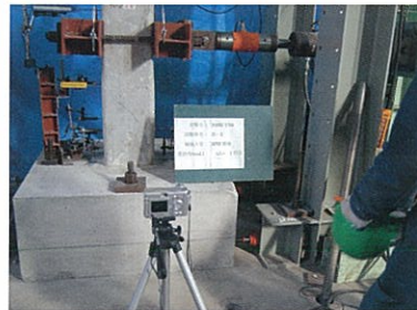
5 セン断破壊試験状況 正側 1/50 第1回目
