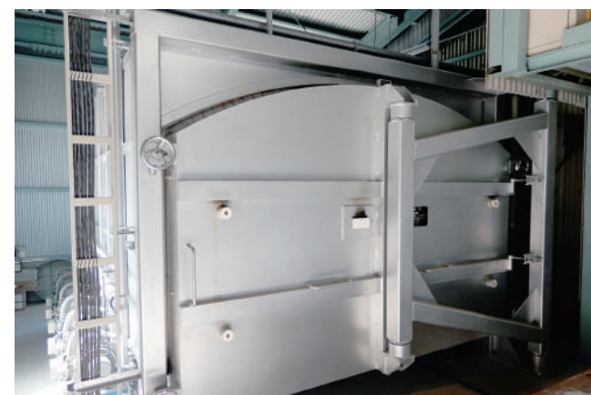
シャトルキルンはプレキャスト製品に最適な温度で焼成する
