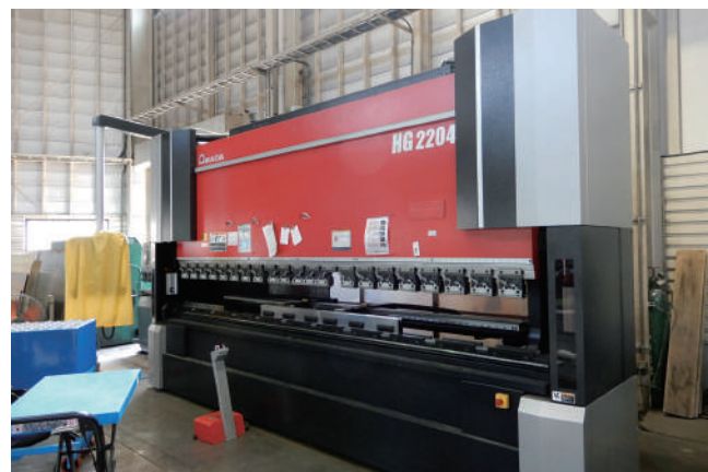
高品質な曲げ加工が可能なプレーキプレス機
