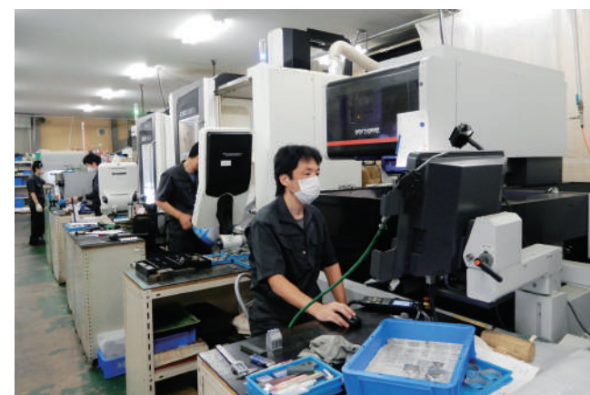
従来に比べて1.7倍の大きさに対応した放電加工機
