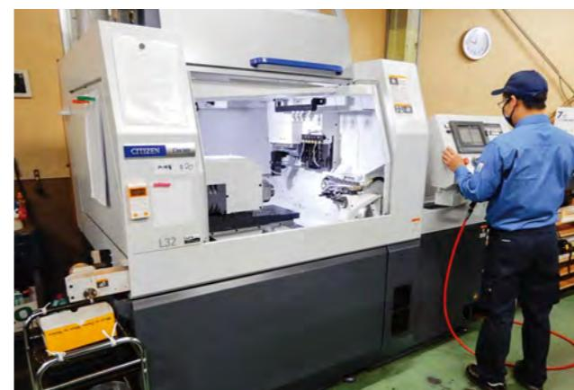
導入した主軸台移動形のCNC旋盤
