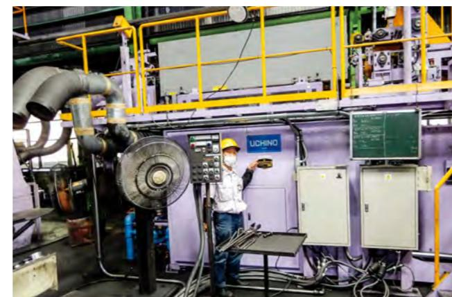
エアハンマーの能力に対応した加熱炉を導入
