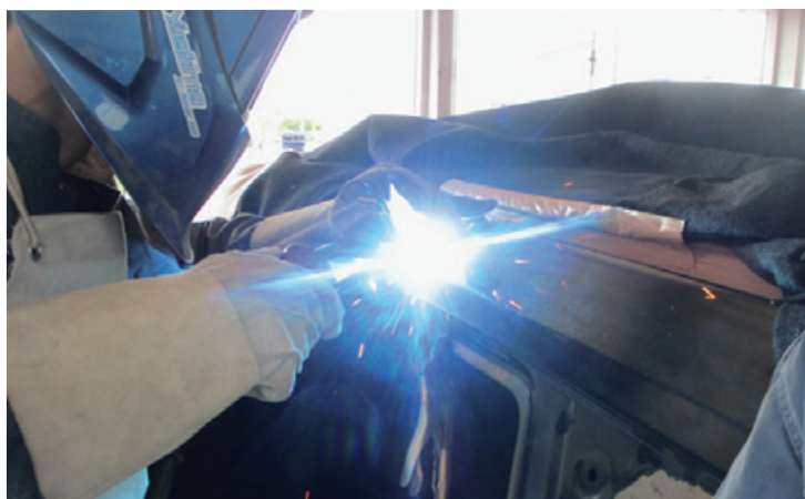
アーク溶接による車体補修の様子
