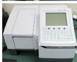
原子吸光度計(写真上) 紫外可視分光光度計(写真下)
