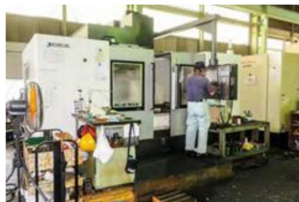
高精度立型マシニングセンターを導入し手戻りのない加工を実現
