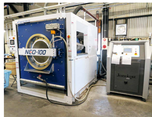
ナノバブル加工機『e-Flow（右）』と、専用の洗濯脱水機（左）
