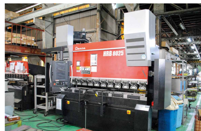
導入したプレスブレーキ。難易度の高いステンレスの曲げ加工に対応
