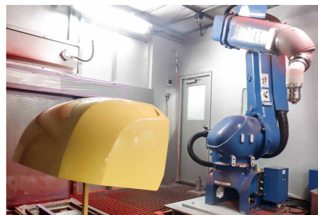
ロボット塗装システム
