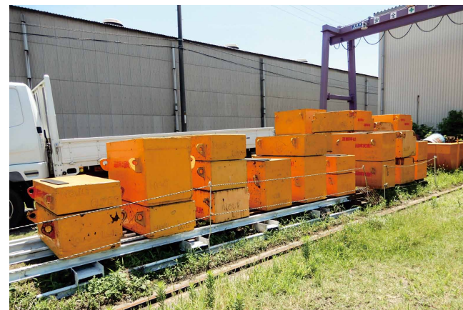
耐荷重試験で使用する点検用ウエート
