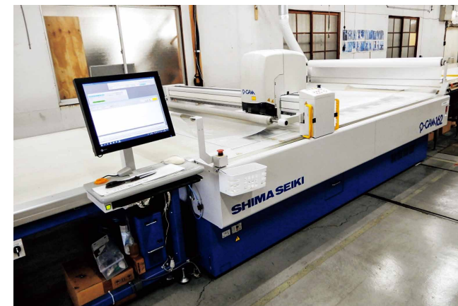
積層式自動裁断機の導入で5割を自動化
