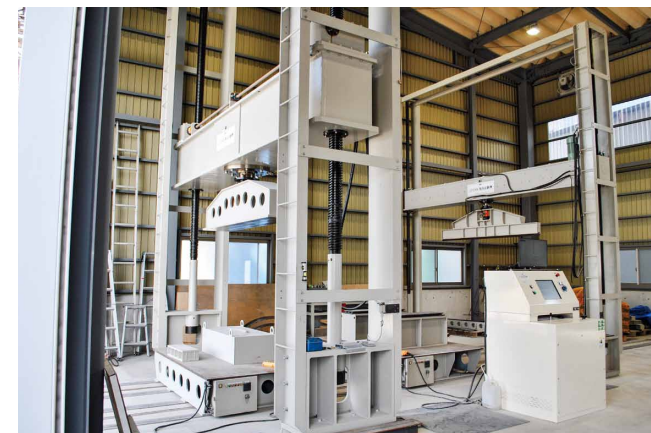
試験機の最大荷重が2倍になり、大型製品の製造・開発が可能に
