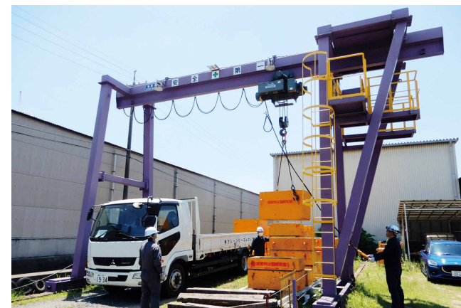
導入した吊り上げ荷重5トンの門型クレーン
