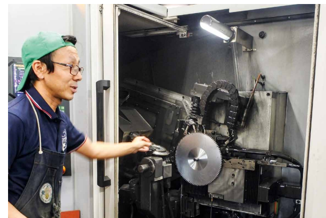
リードタイムを半減した非鉄用チップソー再研磨機で作業
