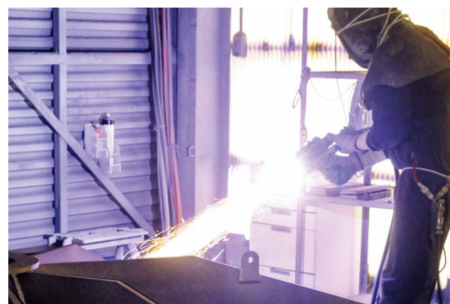
工場における受圧板の溶射作業
