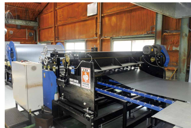
コイル材(写真左奥)と自動定寸切断機で、コスト削減と1人作業(省人化)を実現
