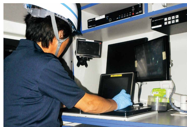
下水道管内点検・調査用のTVカメラシステムで地上で作業が可能
