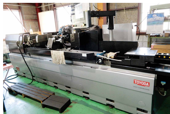
導入した円筒研削盤はアンギュラ研削にも対応
